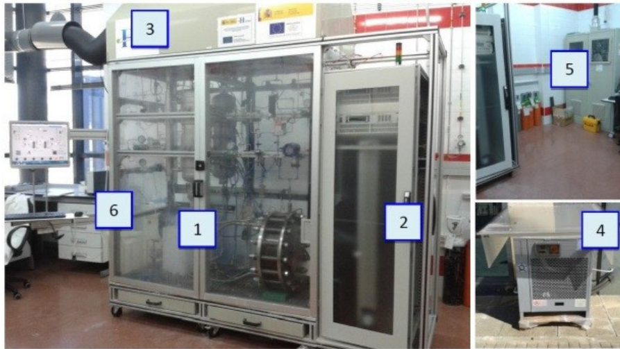
Figura 2. Stack de electrolisis alcalino de 15 kWe integrado en el banco de ensayos de electrolisis
